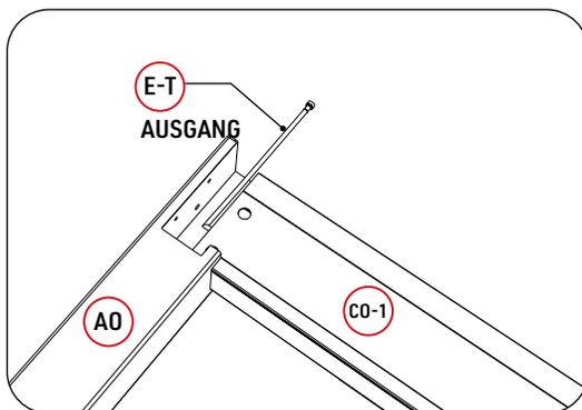
Verwenden Sie den Akkuschauber, um die Schrauben am Pfosten zu befestigen, und ziehen Sie die Schrauben anschließend mit dem Schraubenschlüssel fest.
