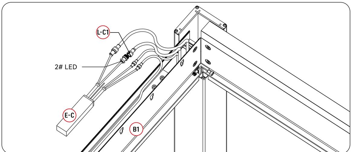
Installieren Sie alle LED-Streifen in einer Reihe und verbinden Sie anschließend die beiden Enden des LED-Streifens mit den beiden Ausgangsleitungen des LED-Controllers (L-C1).
