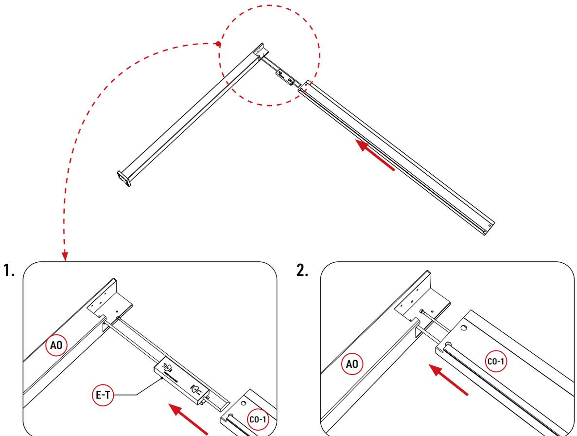
Verbinden Sie den Balken (CO-1) mit dem Pfosten (AO) wie im unten gezeigten Bild. Bitte denken Sie daran, das Stromkabel (E-T) außerhalb des Balkens zu halten.
