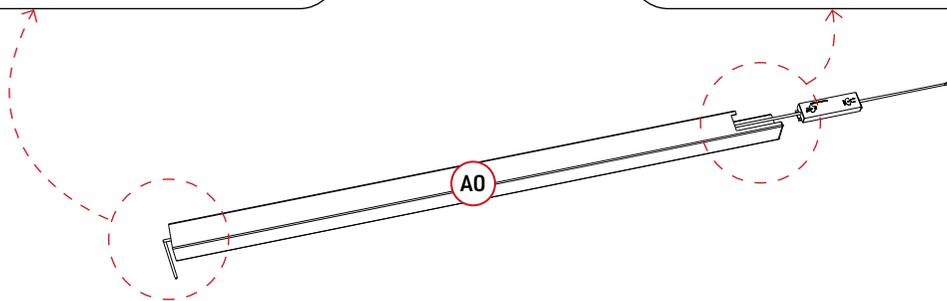
Setzen Sie die Abdeckung (IO) auf den Pfosten (AO). Bitte beachten Sie, dass die Aussparung an der Abdeckung und die Entwässerungsöffnung des Pfostens wie im unten gezeigten Bild ausgerichtet sein müssen.
