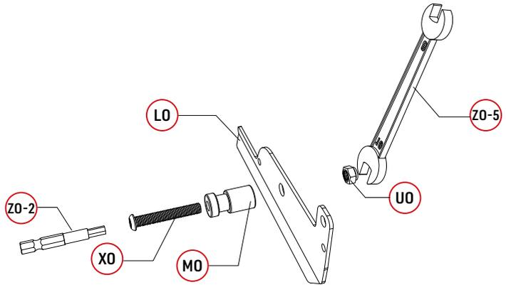
Montieren Sie die Antriebe für die Lamellenabdeckung auf beiden Seiten der Lamellen.
